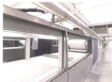
La pressa senza stampo presso lo stabilimento Laminam
